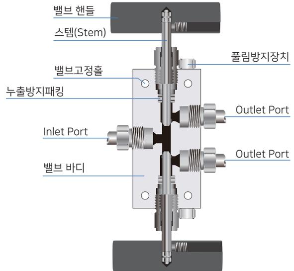
3way 2stem 니들밸브는 기본적인 니들밸브에서 약간 변형된 구조로 하나의 Inlet Port와 두 개의 Outlet Port로 되어 있으며 각각의 Outlet Port를 On/Off 할 수 있습니다. 주로 두 개의 라인에 설치하여 한 개의 라인을 사용하며, A/S가 필요할 경우 By-pass 라인으로 바꾸어 장비를 지속적으로 사용 가능하도록 만든 제품입니다.
