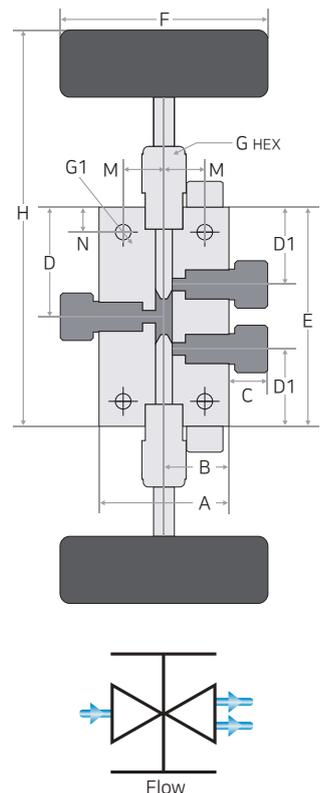
G: Gland부(바디 평면)를 이용한 장착 타공 Size
